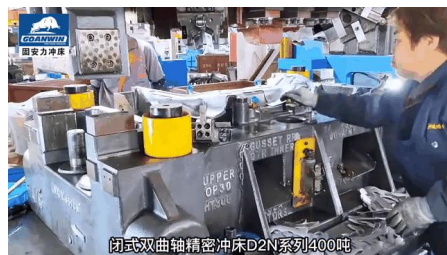
闭式双曲轴精密冲床D2N系列400吨
